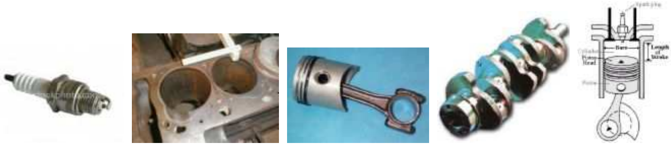
De izquierda a derecha: Bujía; Cilindro; Pistón; Cigüeñal; y todas esas partes ensambladas en el extremo derecho
